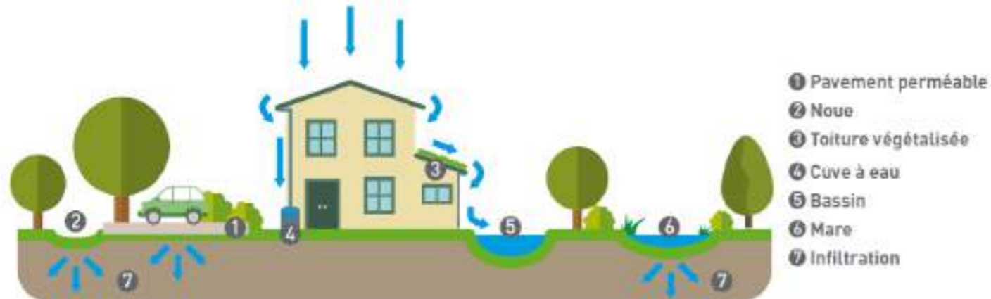
Figure 1 : Principe de gestion alternative, SYMASOL, Guide pour la mise en œuvre de techniques alternatives
